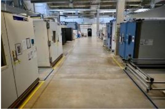
Die Testsysteme für die Prüfung von Sicherheitskomponenten umfassen mehrere hochmoderne Lebensdauer-, Umwelt-, Material- und Funktionstests für Airbags oder Lenkräder. Die jüngsten Anschaffungen umfassen verschiedene Systeme zur Abdeckung einer 7-stufigen Umweltsimulationstestreihe, die zur Bestätigung der Zuverlässigkeit bzw. Sicherheit von Airbag-Modulen oder Lenkrädern erforderlich ist.
