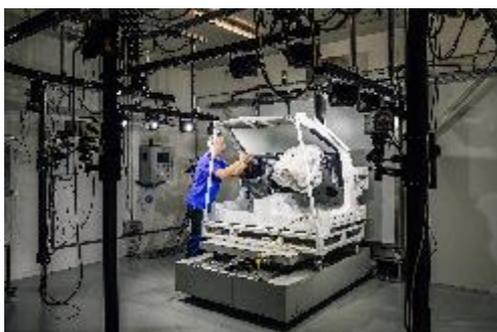
*Ein Experte analysiert den Airbagschuss, um festzustellen, ob sich das Airbagsystem gemäß den erforderlichen Spezifikationen öffnet. Falls die fliegenden Partikel außerhalb der Toleranz liegen und sich das System unerwartet verhält, muss es neu konstruiert werden.*
