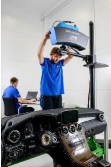
*Der 3D-Scanner erfasst die Oberfläche vor und nach den belastenden Hitze- und Klimawechseltests. Diese Unterschiede sind für das ungeschulte menschliche Auge schwer zu erkennen, werden aber von der Software mit einer Verformungskarte in Farbe dargestellt.*
