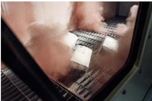
*Im Staubtest wird mit einem speziellen Wüstenstaub aus Arizona über einen Zeitraum von fünf Stunden die langfristige Funktionsfähigkeit des Airbag-Moduls sichergestellt*
