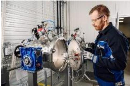
*Bei dem Gasgeneratorauslösungstest wird ein bestimmter Teil des Airbags, der Gasgenerator, ausgelöst. Je nachdem, welcher Airbagtyp geprüft wird (Beifahrer-, Fahrer-, Seiten- oder Kopfairbag), werden drei verschiedene Tanks verwendet. Am Ende der Prüfung des Airbag-Moduls wird der Gasgenerator ausgebaut, und die Experten analysieren, ob der Auslösungsdruck den Spezifikationen des Kunden entspricht.*
