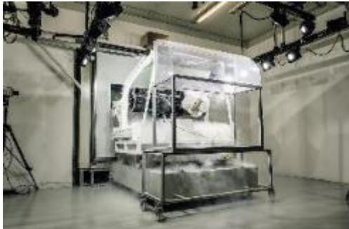
*In unserem Airbag-Testzentrum verwenden wir Hochgeschwindigkeitskameras, die während der Entfaltung des Airbags bis zu 5000 Bilder pro Sekunde aufnehmen.*
