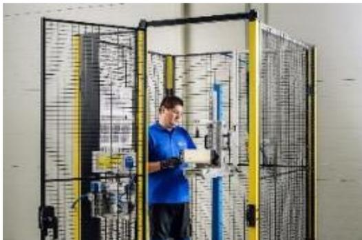
In der Umweltsimulationstestreihe für Sicherheitskomponenten ist der Falltest der erste Schritt im Prozess. Ein Airbag-Modul oder Lenkrad wird über eine Stiftsteckverbindung aus ca. 800 bis 1500 mm Höhe auf eine feste Stahloberfläche fallen gelassen. Dieser Test hat den Zweck, mögliche Schäden an den Produkten zu beobachten.
