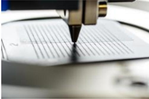
*Das Kratzhärteprüfgerät ist ein universelles Prüfgerät zur Durchführung einer Vielzahl von Tests an Lack- und Kunststoffoberflächen zur Bestimmung ihrer Kratz- und Schnitffestigkeit.*
