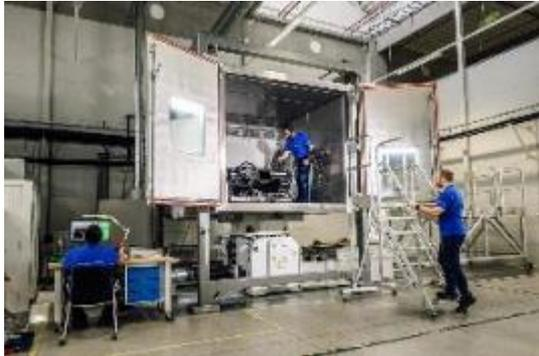
Mit dem dreiachsigen Vibrations-Shaker werden die Belastbarkeit und die Geräusentwicklung von montierten Bauteilen wie einem Lenkrad oder einer Instrumententafel geprüft. Bei Buzz-, Squeak- und Rattle-Tests (BSR) stellen wir sicher, dass unerwünschte Geräusche später im Fahrzeug nicht zu hören sind.
