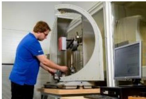
*Das HIT-Pendelschlagwerk deckt den gesamten Bereich der Prüfung der Stoßfestigkeit von Kunststoffen (Charpy, Izod und Dynstat) bis zu 25 Joule ab.*
