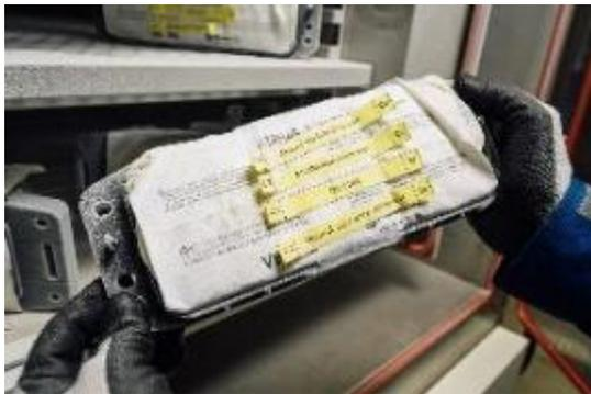
*Die Sicherheitskomponenten werden getestet, indem sie zunächst mit hohen Temperaturen und anschließend mit niedrigen Temperaturen in einem kurzen Zeitrahmen geschockt werden. Damit soll das Risiko eines Produktausfalls aufgrund von Temperaturschwankungen minimiert werden.*
