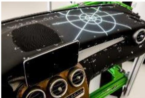
*Der weiß markierte Bereich auf der Instrumententafel kennzeichnet den Airbag-Schusskanal.*
