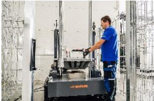
*Der mechanische Schocktest prüft die Widerstandsfähigkeit von Automobilkomponenten. Je nach dem zu prüfenden Teil und seinen Testanforderungen wird das Bauteil einem plötzlichen und kräftigen Zug mit unterschiedlichen Gewichten ausgesetzt, wobei geprüft wird, ob es der Krafteinwirkung standhält.*
