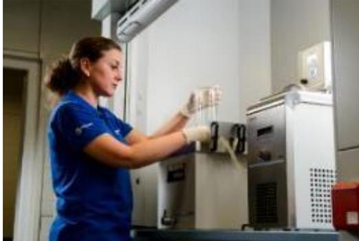
*Das Horizon-Fog-Test-System wird für Emissionstests von verschiedenen Kunststoffen verwendet.*
