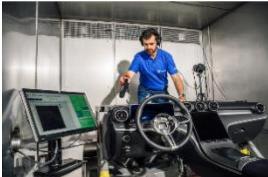
Während des Tests hört und bewertet der Ingenieur, wo es unerwartete Geräusche gibt, z.B. Fahrbahngeräusche, daneben werden aber auch zusätzliche kundenspezifische Tests durchgeführt.
