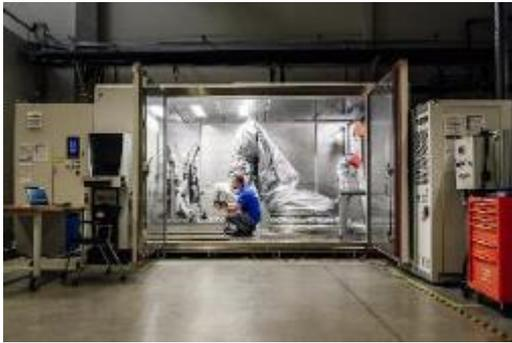
*Ein Roboter, der in endlosen Zyklen die Türgriffe öffnet und schließt, die Knöpfe usw. eines Produkts drückt, um dessen Festigkeit, Stabilität und Haltbarkeit zu prüfen. Aufgrund der zahlreichen atmosphärischen Unterschiede wie Luftfeuchtigkeit und Temperatur ist der Roboter mit einer speziellen Umhüllung ausgestattet.*
