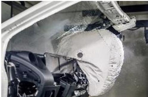
*Als besonders sicherheitsrelevantes Bauteil unterliegen Airbags strengen Vorschriften, wie sie geprüft werden müssen. Bei der Prüfung der Produktionskonformität (COP) werden drei Aspekte während der Entfaltung des Airbags geprüft: die Öffnung der Instrumententafel im Airbagbereich, die maximale Entfaltung (Ausdehnung) des Airbags und der Moment, in dem der Airbag wieder zusammenfällt.*
