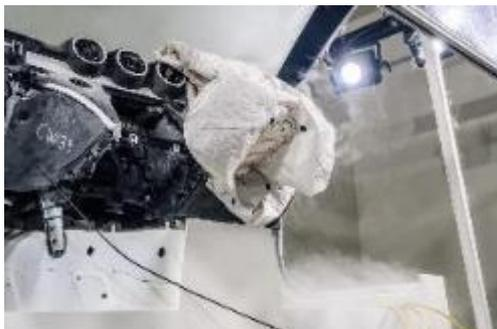
*Diese Airbag-Auslösungen werden bei niedrigen, mittleren und hohen Temperaturen durchgeführt. Die präparierte Instrumententafel muss aus der Klimakammer herausgefahren werden und der Airbag innerhalb von 8 bis 10 Sekunden ausgelöst werden.*
